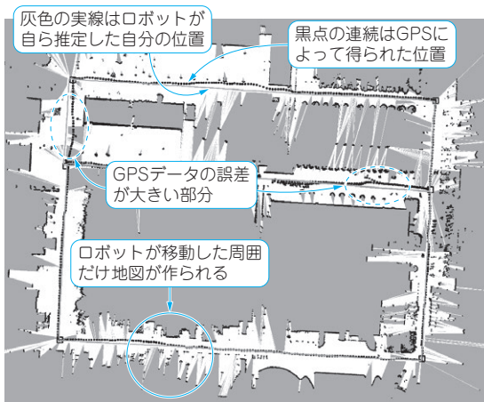
図1 自走ロボで重要な「正確な位置&地図」を推定するSLAMの基本
