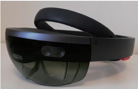
写真1 現実世界に3D表示を組み合わせられるシースルー型デバイス HoloLens
