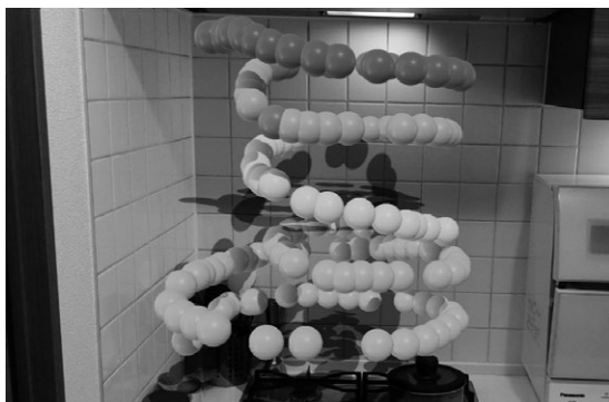
図1 本稿で紹介するセンサ・データ可視化アプリで測った湯沸かし中のガス濃度分布
