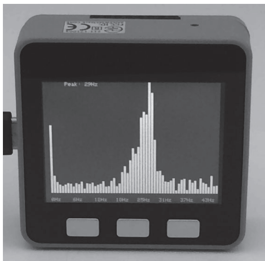
写真1 加速度センサで振動を測定し周波数成分ごとに棒グラフで可視化する
