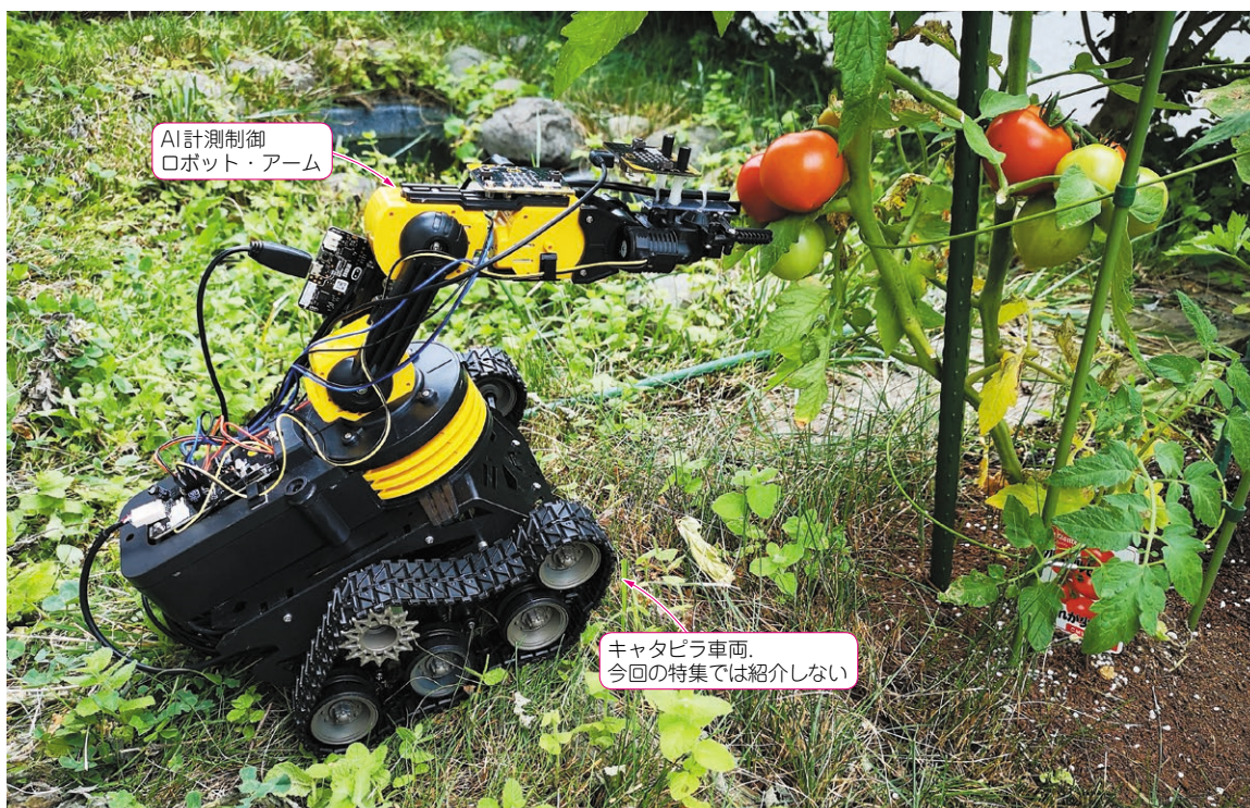
写真1 AIモダン計測制御を行うロボット・アーム トマト発見&キャタピラ移動&自動収穫のロボタンク実験は今回間に合わなかった
