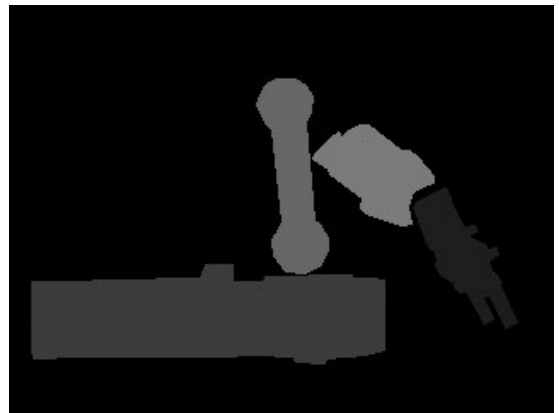
(d) 姿勢2のときのロボット・アーム各部をピクセル単位でラベル付けした学習用画像
