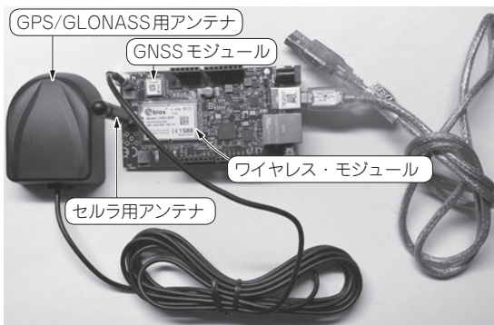
写真1 GNSSレシーバ搭載Mbed互換ボードU-blox C027 Mbed標準ボードLPC1768にUbloxの高精度MAX-7Q GPS/GNSSレシーバとセルラ・モジュール(LISA UMTS/CDMAまたはSARA GSM)を搭載している
