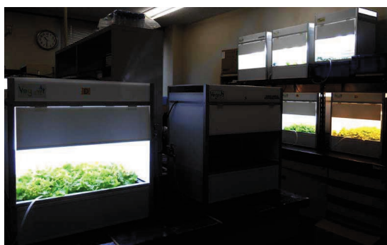
写真1 一般用照明器具を使って栽培試験が行える植物生産装置ベジビット
