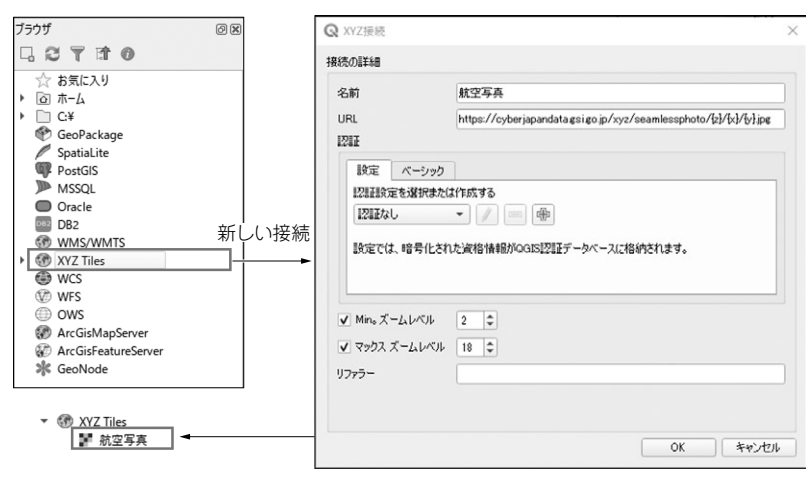
図1 定番地図ソフトQGISのver3は国土地理院の地図タイル取り込みが標準機能になっていて便利 QGISのXYZ Tilesメニューの下に利用可能な選択肢として国土地理院の地図タイル「航空写真」を追加した
