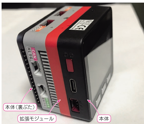
写真2 本体に拡張モジュールを積み重ねるようになっている
