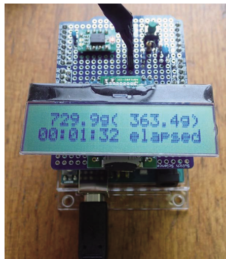
写真2 自作低価格ロードセル重量計測装置
