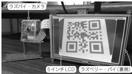
写真1 ラズベリー・パイでzbarcamを動かしてQRコード識別する実験で試す
