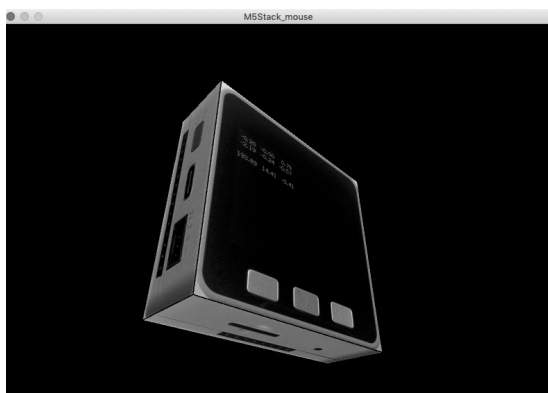
図1 X, Y, Z値を受けてM5Stackの3Dモデルをクルクルと動かす
