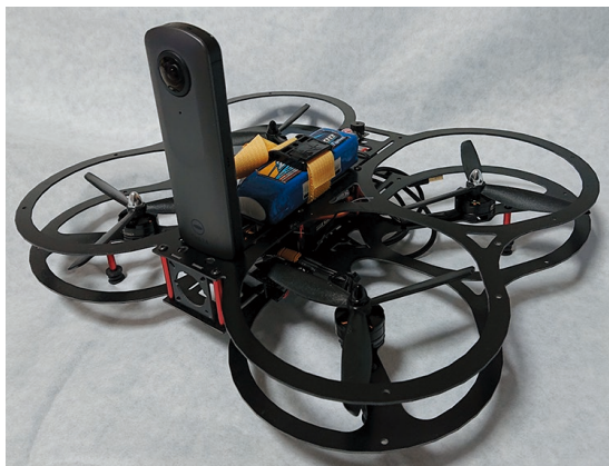
写真1 360°に視野があるカメラを搭載するタイプ
