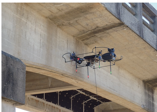
写真3 打音検査機ドローン（提供：日本電気）
