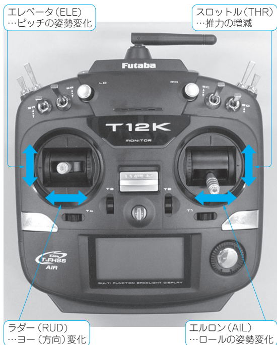
図4 モード1ではスティック操作があらかじめ割り当てられている
