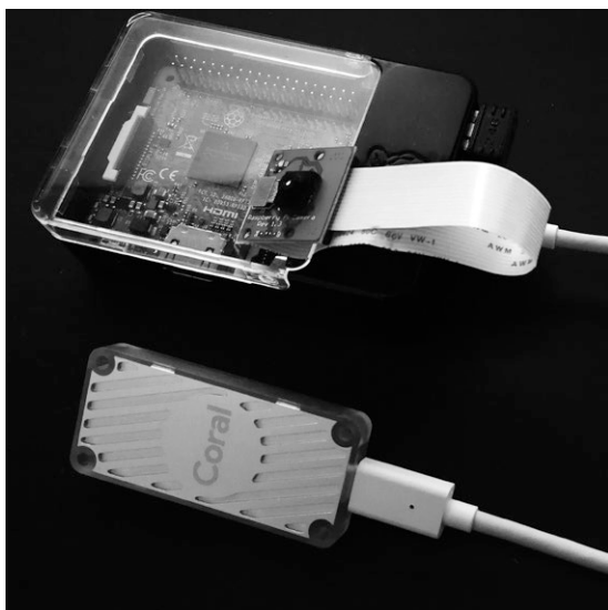
写真1 今回用いるグーグルAIチップEdge TPUのUSB Dongle 既にあるラズベリー・パイ3B+にUSB接続できるGoogle Coral Edge TPU USB Acceleratorを使用した
