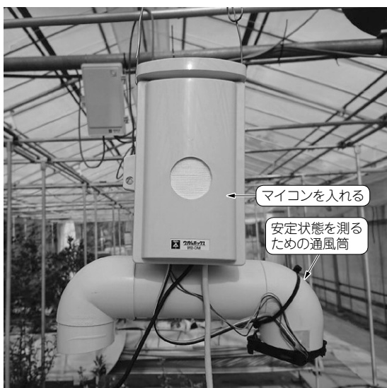
写真1 きちんと温度や湿度を測るための大気センシング部を作る (再掲)
