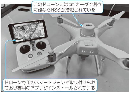
写真1 空中写真の撮影に使用したcm級RTK GPS搭載ドローン Phantom 4 RTK (DJI社)
