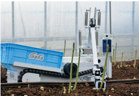
写真1 人工知能は80点取ればOKと割り切った野菜収穫ロボット inahoの自動野菜収穫ロボット。残りは人手で収穫する。「かながわビジネスオーデション2020」で神奈川県知事賞を受賞した(写真提供: inaho)
