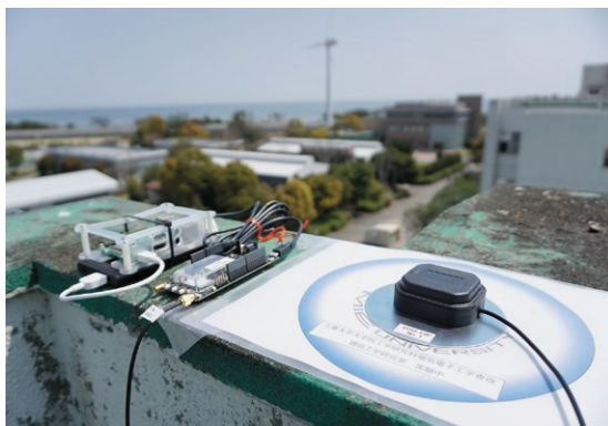
写真1 ラズベリー・パイとcm測位モジュール ZED-F9Pを接続し高精度測位に挑戦
