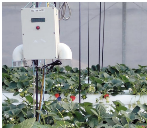
写真2 著者の試験ハウスに設置されているArduino低コストUECS環境計測ノード
