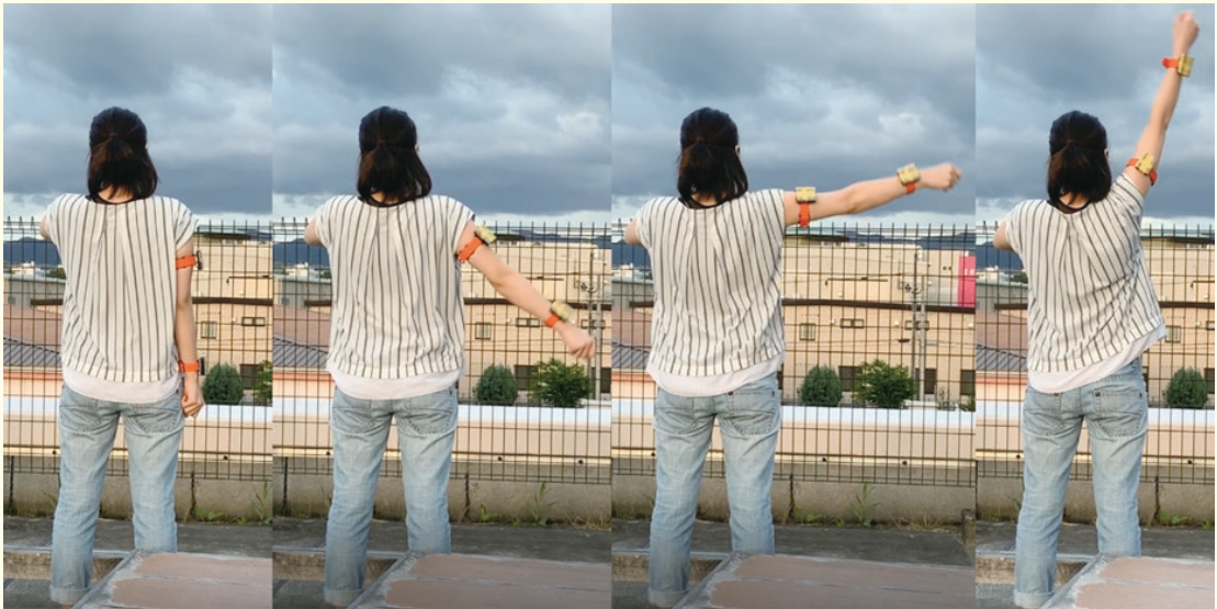
MATLABで作ってマイコンへ載せる！動き計測AIの本格チューンアップ。腕を回す際に、腕を上げる高さ（角度）を5段階に変化させ、20点、40点、60点、80点、100点と得点をつけている→42ページ
