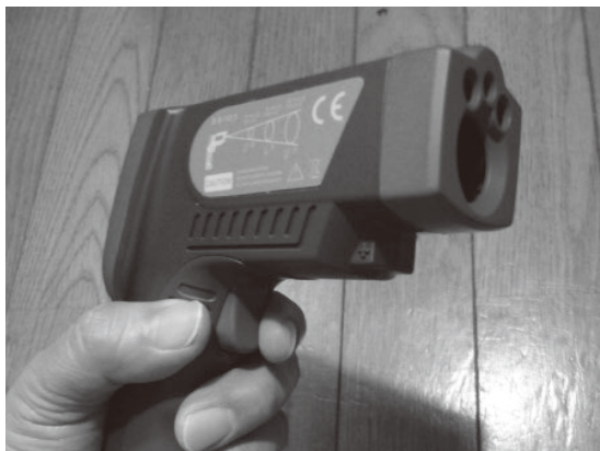
写真1 新型コロナウイルス対策で注目を集める非接触温度計 写真はその一例。HP-320 (HoldPeak)
