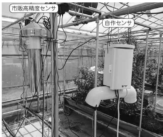
写真1 自作した気象観測センサ(3万円以下)は市販の高精度センサ(20万円)とそんな結果が得られた
