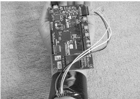
写真1 RISC-V開発ボードと0.1℃以下の分解能の高精度温度センサで簡易体温センシングを行う
