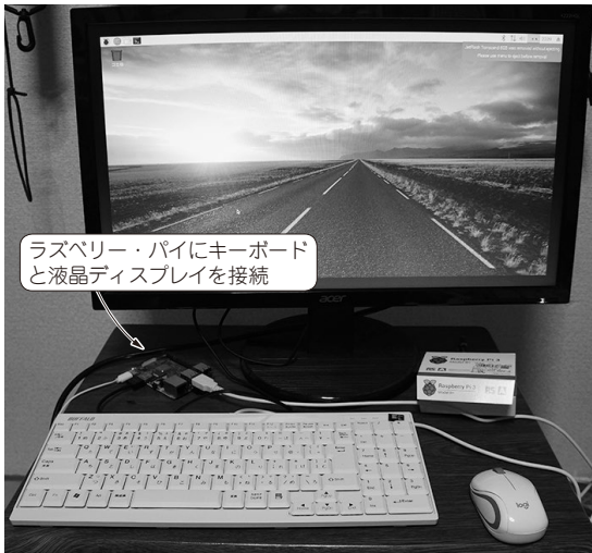
写真1 準備…Raspbianを立ち上げる際にキーボードと液晶ディスプレイを接続した
