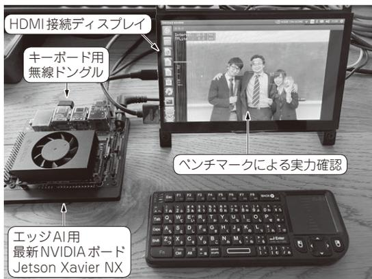
写真1 AI用最新GPUボード Jetson Xavier NXの実力を確かめる
