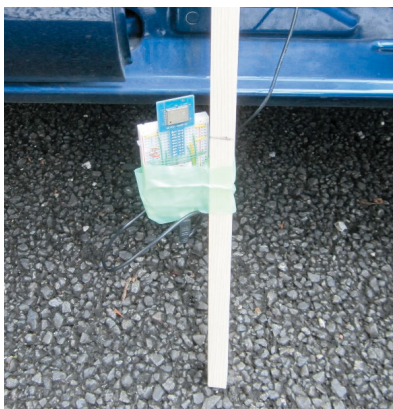
写真1 Wi-Fiモジュールの高さを変えながら通信可能な距離を測った
