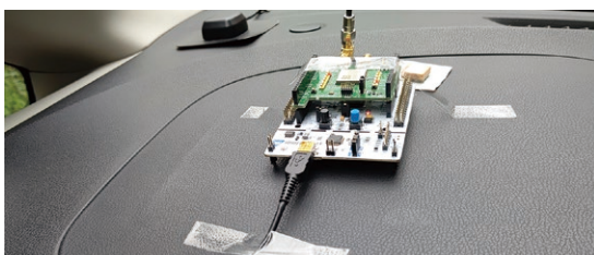
写真8 高速走行時でもデータ収集できるかを実験
