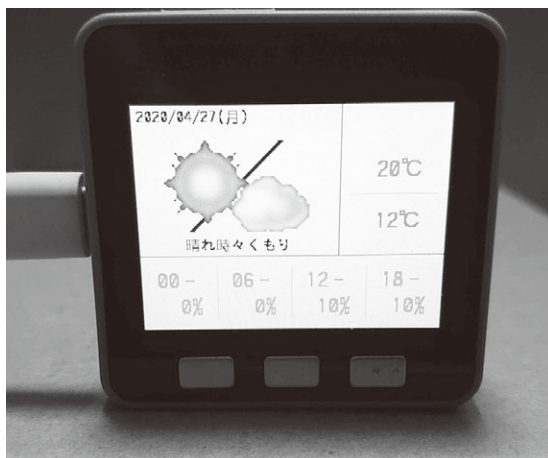
写真1 M5Stackで作ったモバイル・ウェザー・ステーションの様子
