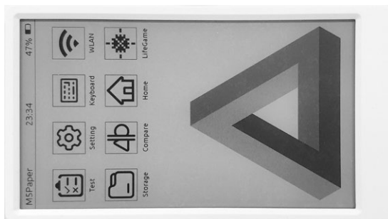
写真1 画面にはLCDよりも視認性の高い電子ペーパーを採用している
