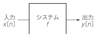
図2 入力に対して処理を行いそれを出力するものをシステムと呼ぶ
