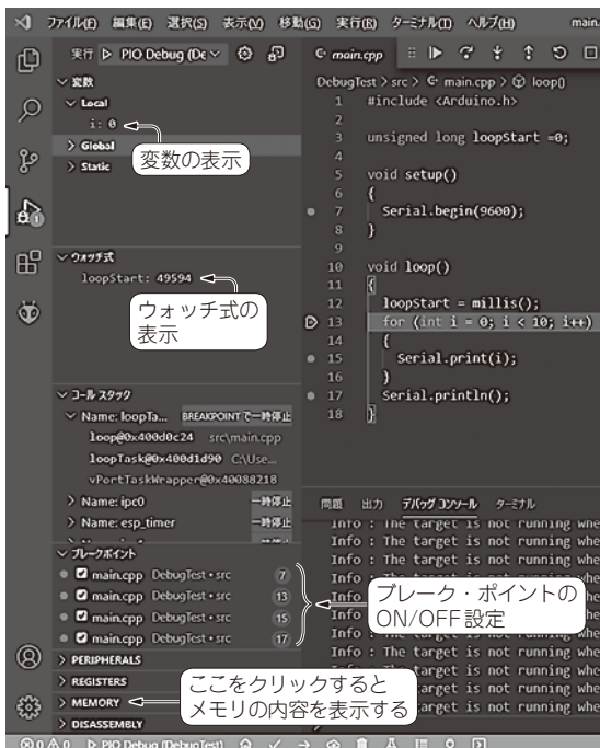
図1 JTAGを使ってデバッグすると実行時の変数やメモリ内容を表示できる
