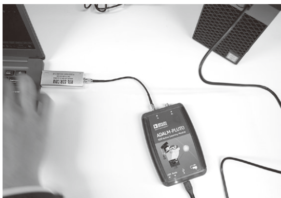
写真1 Python上でFM変調波を生成しADALM-PLUTOから送出するまでを体験する
