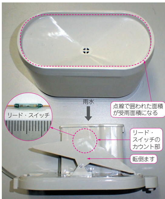
写真1 アマゾンで3000円以下で買える転倒ます型降水量センサ
