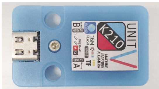
写真4 M5 UNIT V [RISC-V (RV64IMAFDC) デュアルコア、最高400MHz、RAM8Mバイト、M5Stack]
