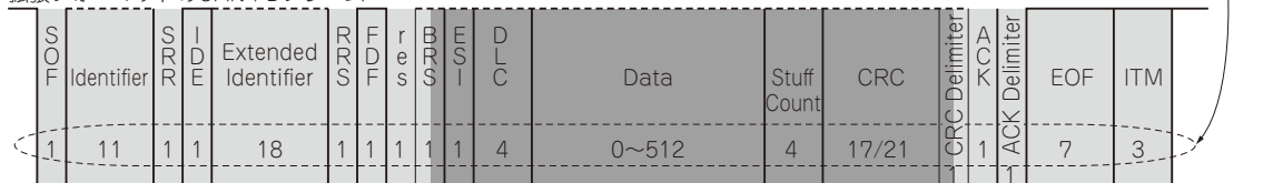
図1 CAN FDのフレーム(色の濃い部分が高速転送)
