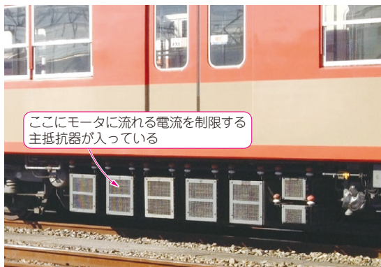
写真2 モータの制御装置は電車の床下に取り付けられている
