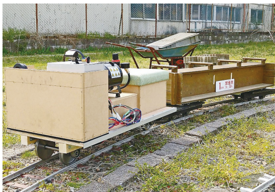
写真1 自作したモータ制御装置で走る5インチ・ゲージの電車
