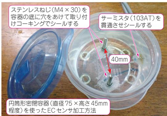
写真1 密閉容器を使ったECセンサ部分の加工方法
