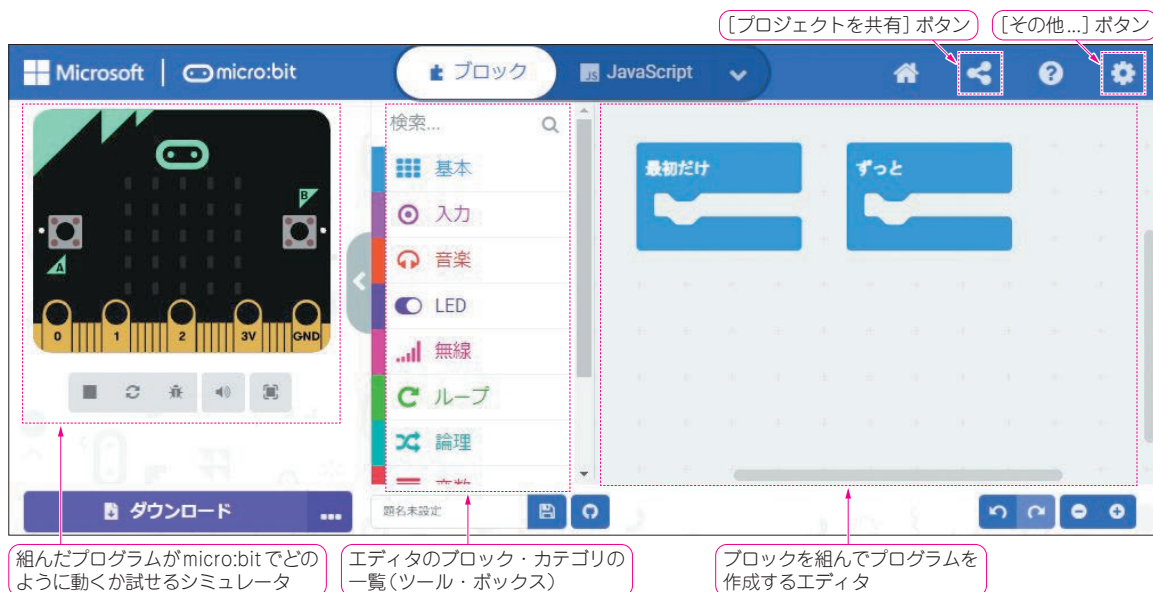
図1 画面上でブロックを組み合わせただけでマイコン・プログラミングができる「MakeCode」
