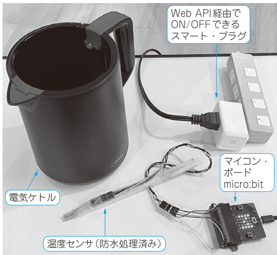
写真1 本章でやること…調理器を例題にブロック・プログラミング環境をベースにした本格IoTシステム作りを体験する micro:bitとスマート・プラグを使ってIoT低温調理器を製作する
