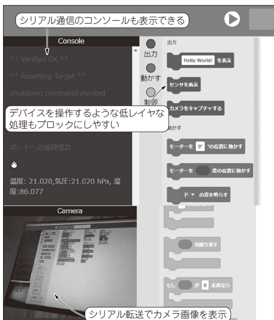
図1 第3部でやること…マイコン制御用C++コードを生成するブロック・プログラミング環境を作る
