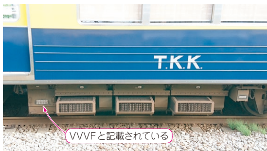
写真1 鉄道車両の下部を見るとVVVFなどの銘板が見つけれられる
