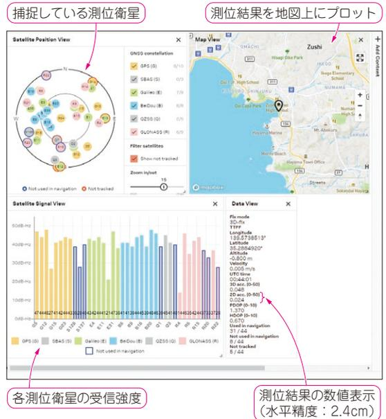
図1 GPS測位で割り出した現在位置を地図上にプロットした例
