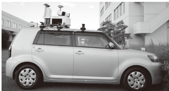
写真1 車両にGNSS受信モジュールを設置して走行しながら計測した
