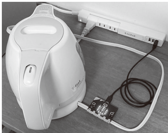
写真1 micro:bitのみでAC通電検出を行っている様子
