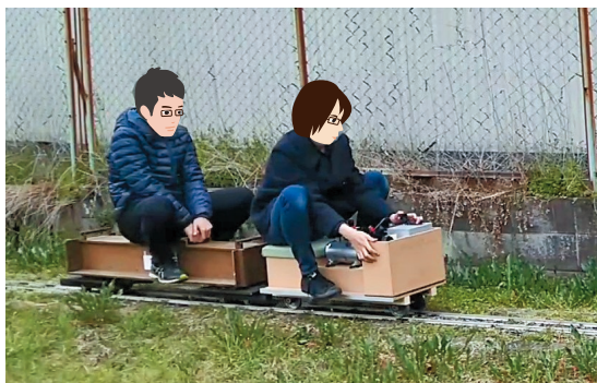
写真1 直流モータで動く5インチ・ゲージの車両を製作した
