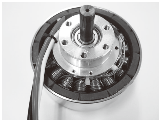
写真1 200WクラスのDCブラシレス・モータ
