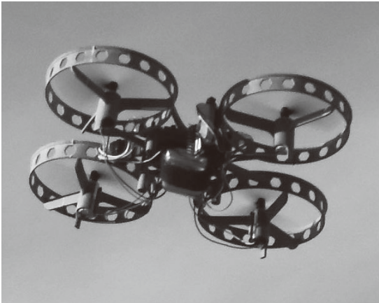
写真1 第3部でやること…MATLAB, Simulinkを使ってドローンのモデリングや飛行制御系の設計を行う 写真は2020年3月号の特集で紹介した200g以下の機体
