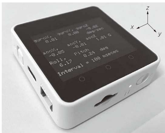
写真1 M5Stack Core2を用いた姿勢推定システム 内蔵する加速度センサとジャイロ・センサの出力データを使って、ロール角とピッチ角を推定する。拡張カルマン・フィルタを使って誤差を少なくする工夫をしている
