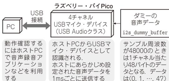
図1 audio\_4\_channel\_micのシステム構成
